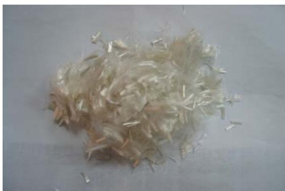
图 2-1 表面作膨胀化处理的玄武岩矿物纤维 1
